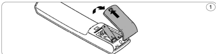
**2** Coloque dos pilas tipo AAA en el compartimento de las pilas, tal y como se muestra.
