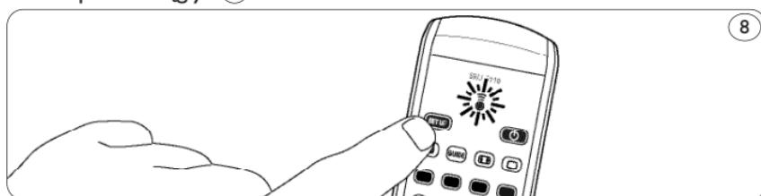
**2** Naciśnij i przytrzymaj przycisk gotowości pilota SRU 5110, aż telewizor wyłączy się (do trybu gotowości). ⑨
