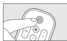
**4** Направьте SRU 4002 на телевизор и убедитесь, что устройство реагирует на нажатие кнопок.
