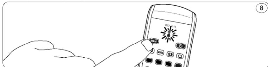
**2** Naciśnij i przytrzymaj przycisk gotowości pilota SRU 5110, aż telewizor wyłączy się (do trybu gotowości). ⑨
