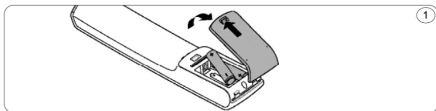
**2** Coloque dos pilas tipo AAA en el compartimento de las pilas, tal y como se muestra.
